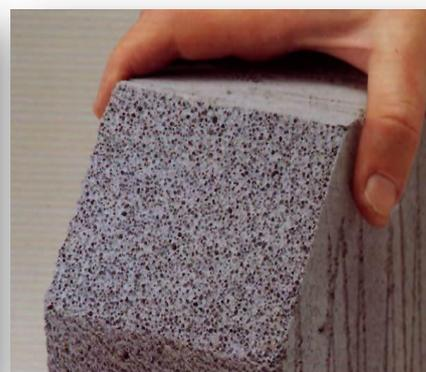
Genfil est mélangé au mortier sous forme de mousse obtenue à l'aide d'un système à air comprimé (générateur de mousse). Aucune réaction chimique n'a lieu avec les autres composants de mortier. La mousse se mélange facilement avec mortier. Les bulles d'air remplacent ainsi l'utilisation de graviers, ce qui allège par conséquent le béton. De plus, les bulles d'air sont bien réparties et finement calibrées (les cellules) garantissant un béton cellulaire solide.
